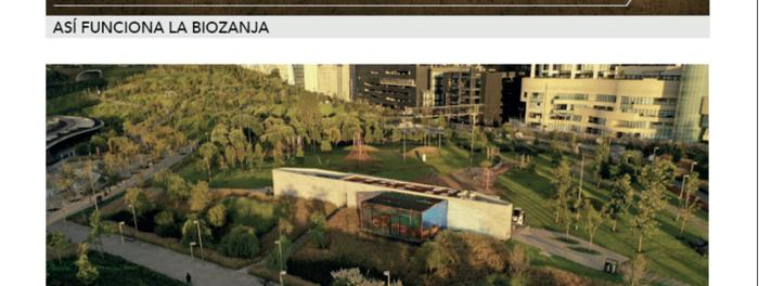
El parque cuenta con un eje hídrico que se extiende longitudinalmente y que va captando las aguas de lluvia en una "biozanja" que la infiltra y conduce hasta llegar a un nuevo lago y a una enorme cisterna que recibe y retiene dichas aguas.
